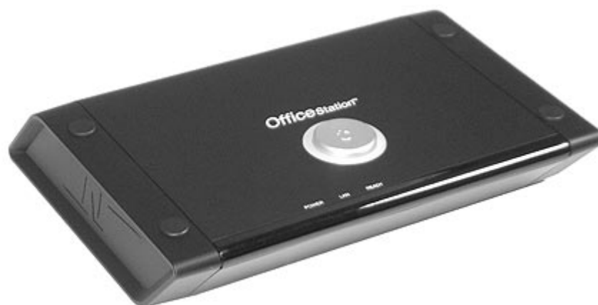
Der SmartClient OfficeStation mit Einknopfbedienung
